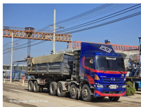
ภาพที่ 2.2-11 การปิดคลุมรถบรรทุก
